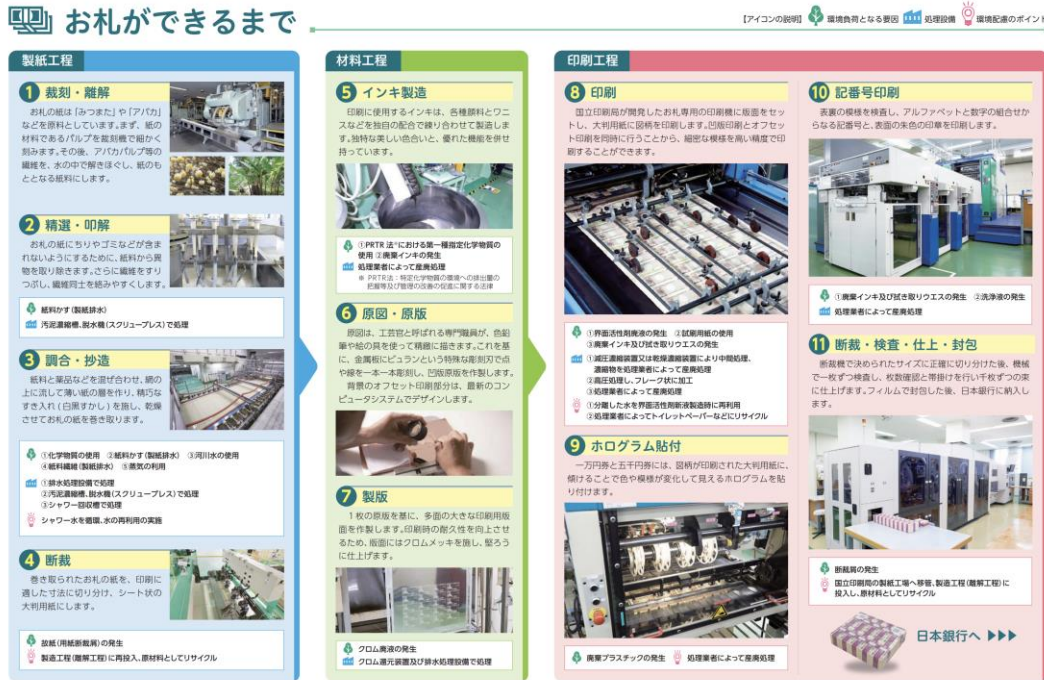
図表 72 紙幣の製造プロセス
